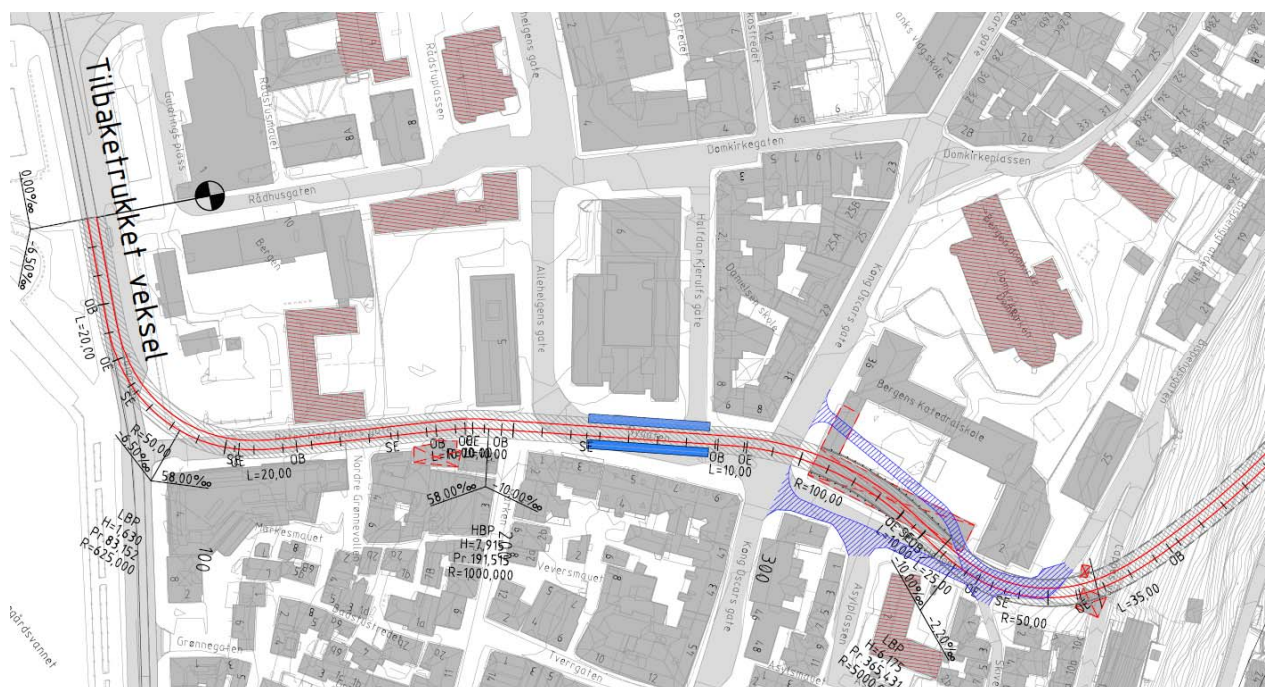
Planlegningen over viser en baneteknisk løsning for Multiconsult sin variant 2. Blå skravur viser mulig biltilkomst.
